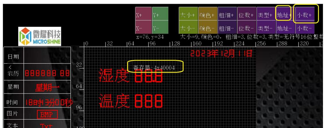
节目中地址是 从 0x40001 开始， 在节目中选择 modbus 变量后，控制按钮，点 “地址+”，加到温度地址是(0x40001+3) =0x40004,温度地址是 (0x40001+4) =0x40005,根据手册 湿度为 11.2 和 13.9 通过点“小数+”出现小数点后 放置小数点在 88.8.更新节目后 可以看到 led 屏显示一位小数。
