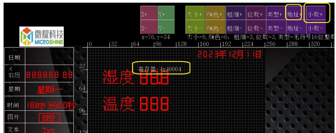
节目中地址是 从 **0x40001** 开始，在节目中选择 modbus 变量后，控制按钮，点 “地址+” “”，加到温度地址是(**0x40001+3**)=**0x40004**, 温度地址是 (**0x40001+4**)=**0x40005**, 根据手册 温湿度为 11.2 和 13.9 通过 点 “小数+” 出现小数点后 放置小数点在 88.8. 更新节目后 可以看到 led 屏显示一位小数。
